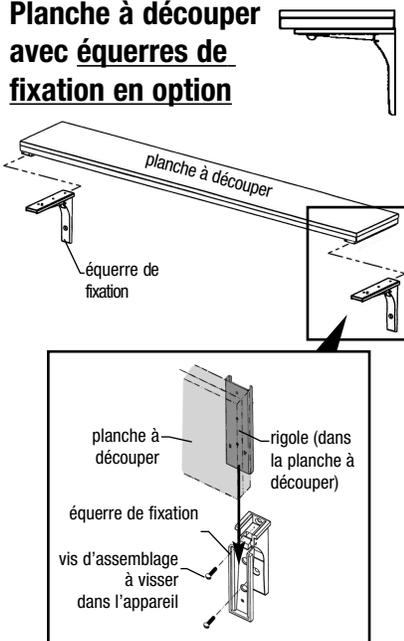
1. Fixez les équerres à la Desserte à l'aide des vis d'assemblage et fixations filetées.
