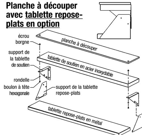
1. Fixez les supports à la tablette de soutien en utilisant les écrous borgnes, les rondelles, les boulons et les trous pré-perçés. Remarque : les écrous borgnes doivent être en haut.
