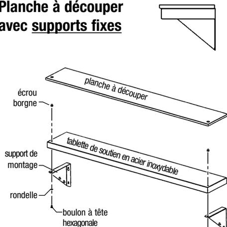
1. Fixez les supports de montage à la tablette de soutien, en utilisant les écrous borgnes, les rondelles, les boulons et les trous pré-perçés. Remarque : les écrous borgnes doivent être en haut.
