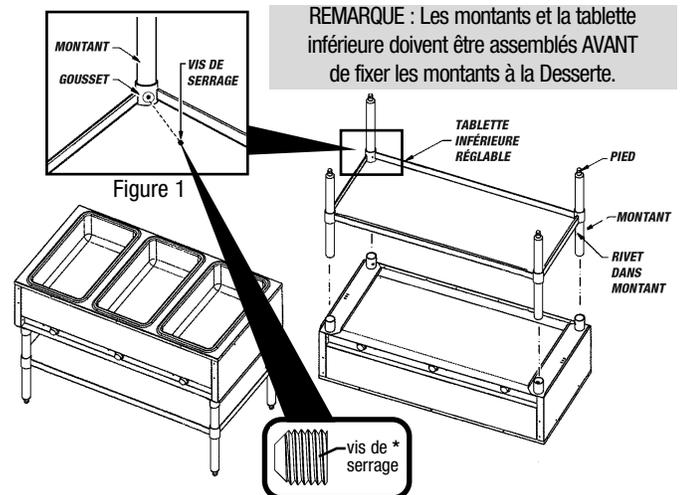
REMARQUE : Les montants et la tablette inférieure doivent être assemblés AVANT de fixer les montants à la Desserte.
