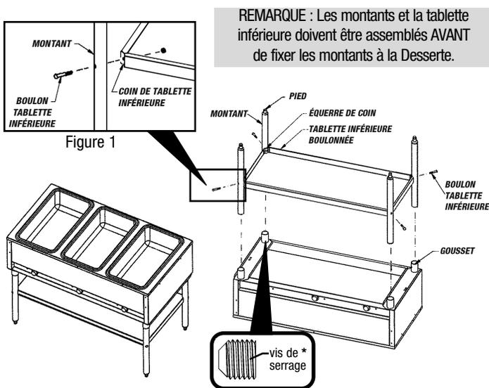
REMARQUE : Les montants et la tablette inférieure doivent être assemblés AVANT de fixer les montants à la Desserte.
